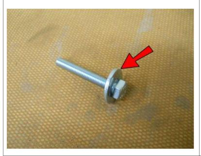
Place a 1/4" Washer onto an M6-1.0x40 Bolt.
