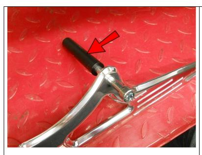
Slide a 3.6" Spacer onto the bolt.
